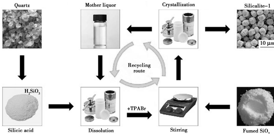
图 3 回收母液合成 Silicalite-1 示意图<sup>[14]</sup>
