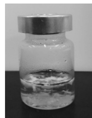
图 4 喹啉-2-甲酰肼的甲醇溶液加热溶解后冷却
